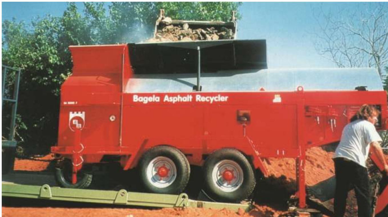
Wtórna przeróbka zerwanego z nawierzchni asfaltu
