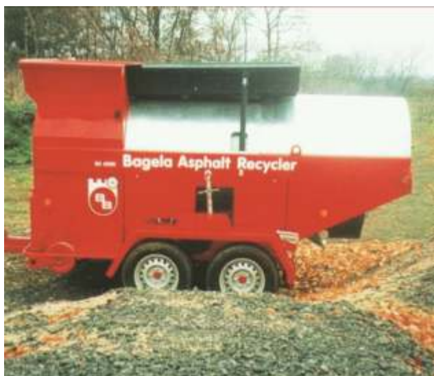
Wtórna przeróbka frezowanego materiału nawierzchni
